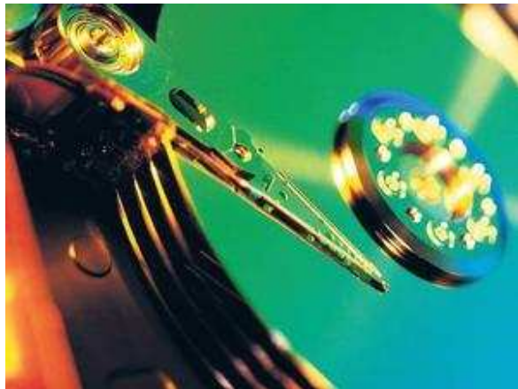
Anfällig. Eine Computerfestplatte verzeiht keine heftigen Stöße. Das Ausfallrisiko nimmt zudem durch die hohen Umdrehungszahlen aktueller Massenspeicher zu. - FOTO: IBM/DPA/GMS
